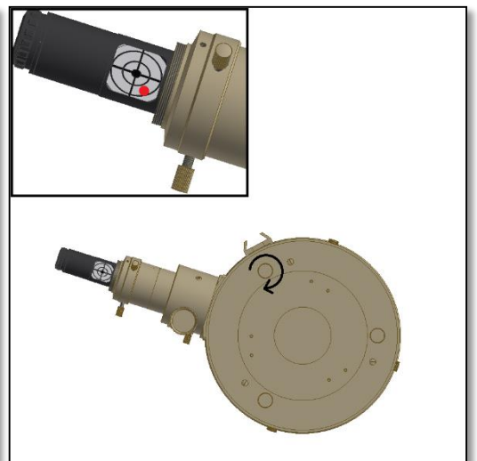
Figura 4. Inserire il collimatore del laser nel tubo del foceggiatore. Assicurarsi di averlo stretto come se si trattasse di un oculare.
