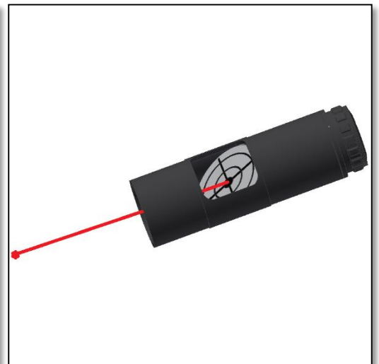
Figura 2. Ruotare la parte superiore per accendere il laser.
