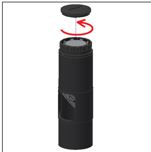
Figura 1. Togliere il coperchio per accedere alla batteria.
